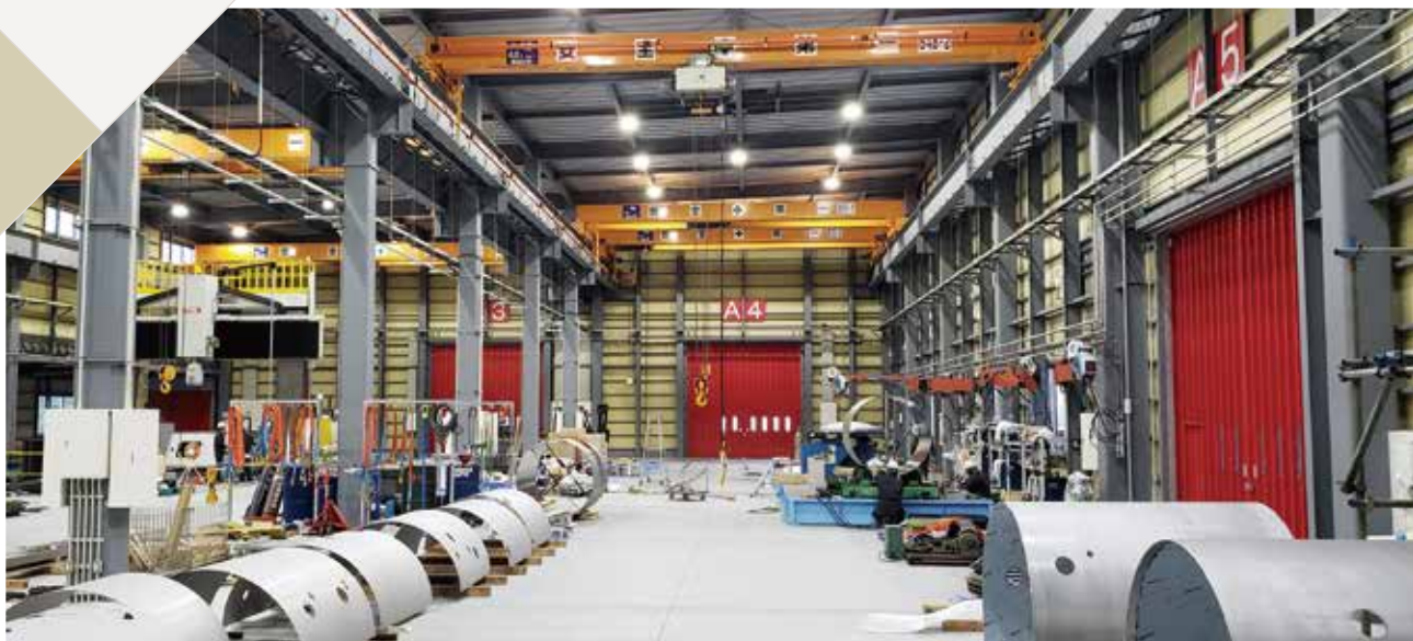
クリアパーク延岡工場 機械・製缶棟 30m×80m 天井クレーン 10t×2台 4.8t×2台 吊り代8.6m
