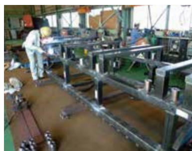
角パイプフレーム製缶
